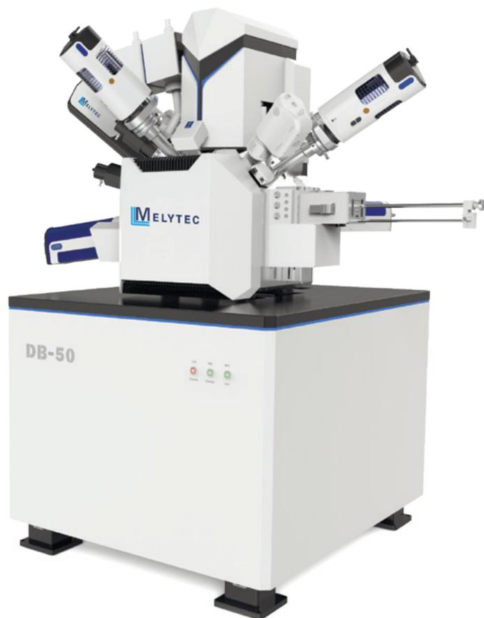
DB-50 – это двулучевой сканирующий электронный микроскоп высокого разрешения с катодом с термополевой эмиссией типа Шоттки. Прибор обладает широкой вакуумной камерой и большим предметным столом, удобной оптической навигацией по образцам, имеет обширный выбор детекторов, а также порты для установки дополнительного аналитического оборудования и проведения динамических экспериментов (нагрев, охлаждение, сжатие, растяжение и т. д.).
